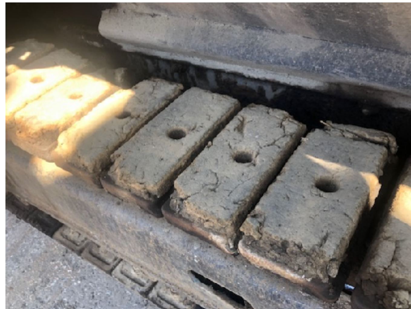
クローラーひび割れ
