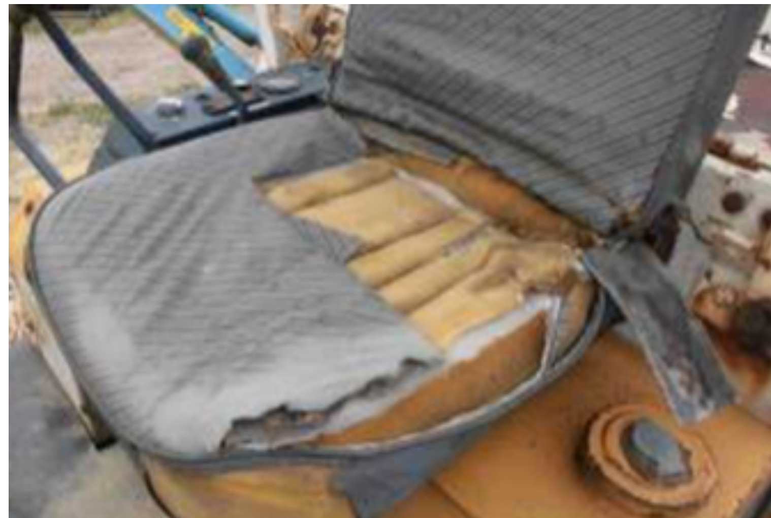
シートカバー破損
