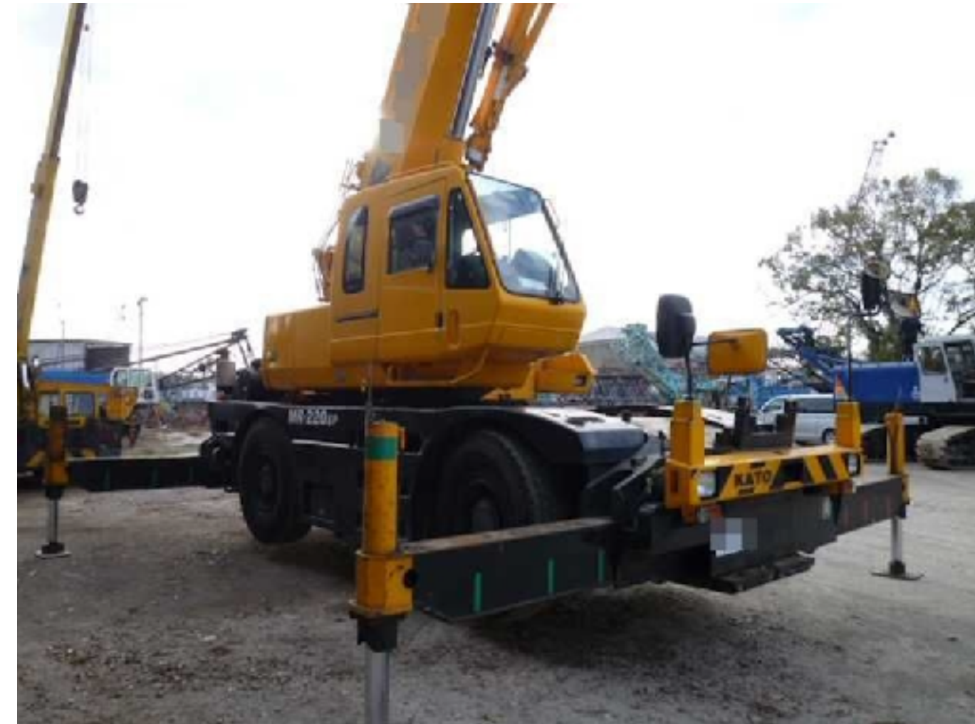
アウトリガー張り出し時
