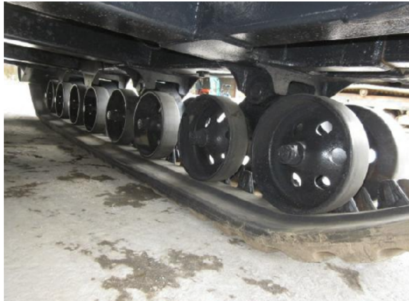
右クローラー全体内側
